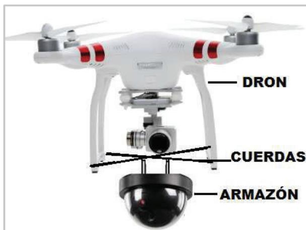
Figura 2.21 Armazón Sistema Aéreo
