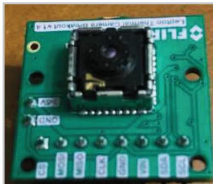
Figura 2.9 Cámara térmica Flir Lepton
