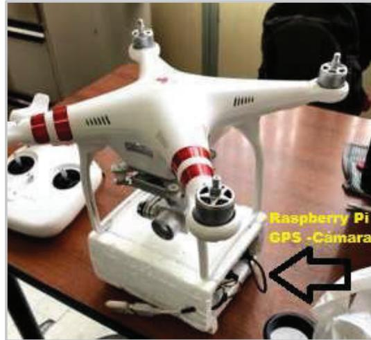
Figura 2.57 Armazón de espuma flex
