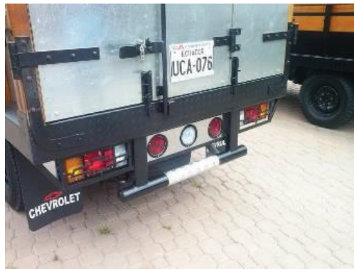
Figura 3.10. Dispositivo antiempotramiento de un solo tubo del camión Chevrolet modelo NLR. (Fuente: Los autores)
