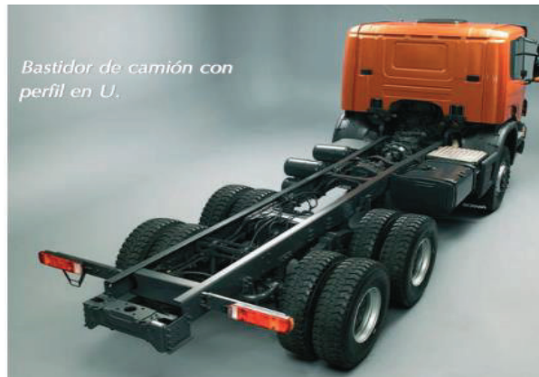
Figura 1.10. Bastidor con perfil en U. (Fuente: http://www.escueladeltrabajo.net/bastcamion.pdf )
