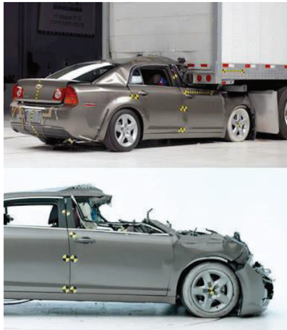
Figura 1.2. Efectos de colisión con dispositivo antiempotramiento deficiente. (Fuente: http://www.investigacion-reconstruccion-traffic.blogspot.com )
