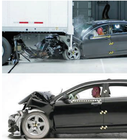
Figura 1.3. Efectos de colisión con dispositivo antiempotramiento adecuada. (Fuente: http://www.investigacion-reconstruccion-traffic.blogspot.com )
