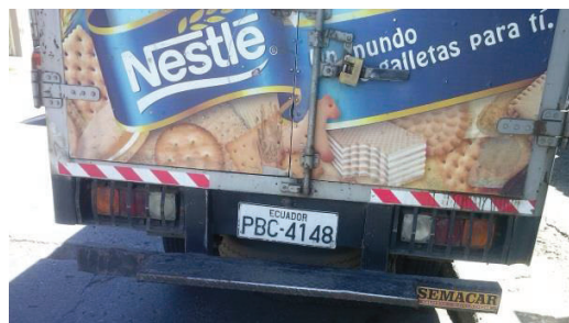
Figura 3.5. Dispositivo antiempotramiento de plancha corrugada. (Fuente: Los autores)
