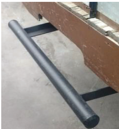
Figura 3.3. Dispositivo antiempotramiento de un solo tubo. (Fuente: Los autores)
