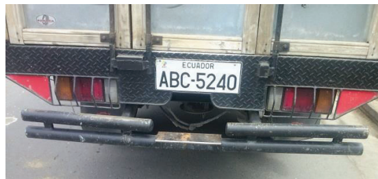
Figura 3.4. Dispositivo antiempotramiento de doble tubo. (Fuente: Los autores)
