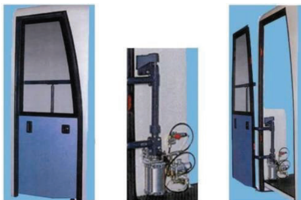
Figura 17. Apertura de puerta, sistema neumático. (Fuente: http://www.isaf-bus-components.com/spagnolo/puertaREN.htm )
