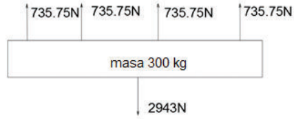
Figura 41. Diagrama de fuerzas actuantes sobre la viga. (Fuente: Propia).
