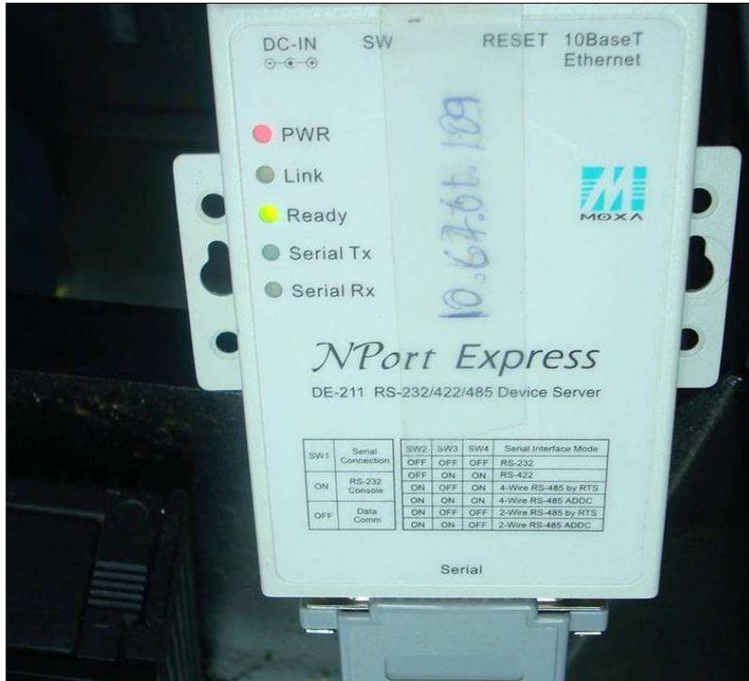
Figura 2.13. NPort, nótese en la parte inferior el conector DB 25.
