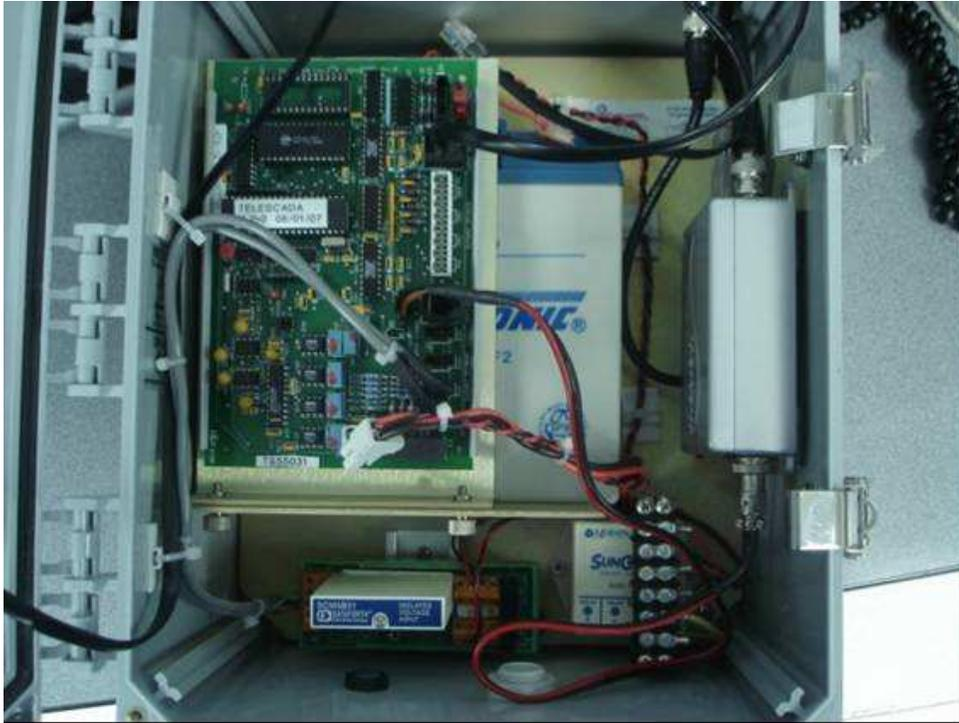
**Figura 2.3** Circuito de control del Telescada ATS 8CCM utilizado en el proyecto.
