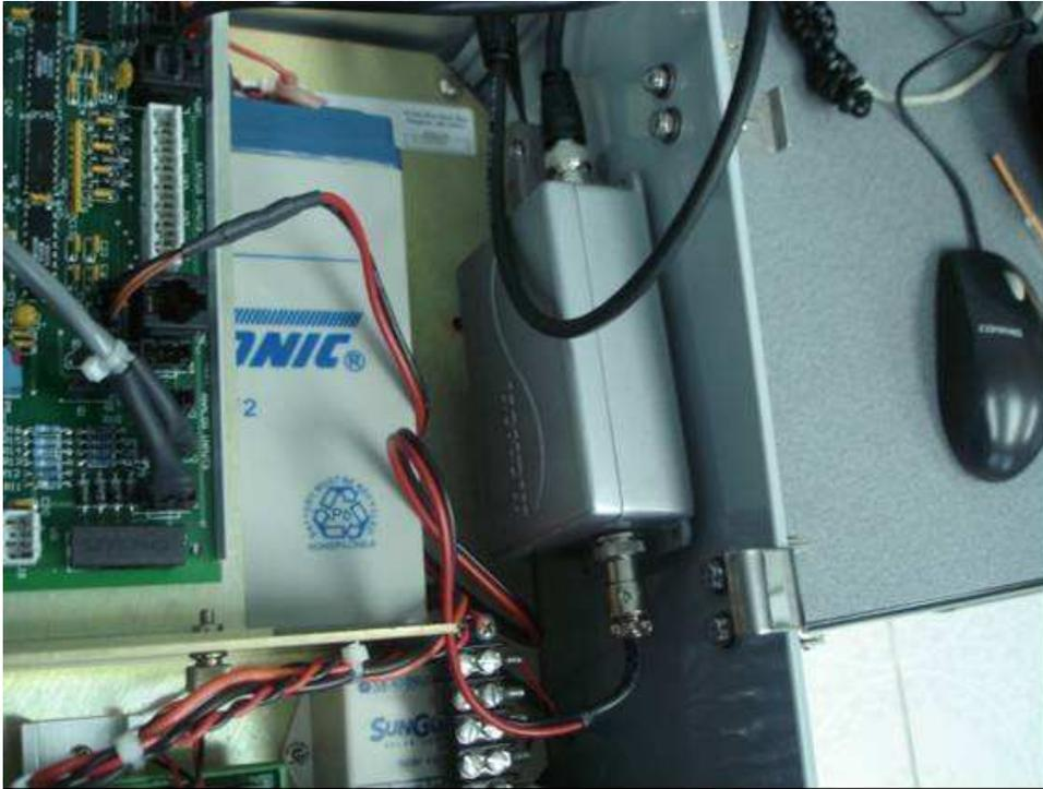
**Figura 2.16.** Radio Midlan conectado. En la parte inferior se pueden apreciar el cable que conecta la alimentación hacia la tarjeta.
