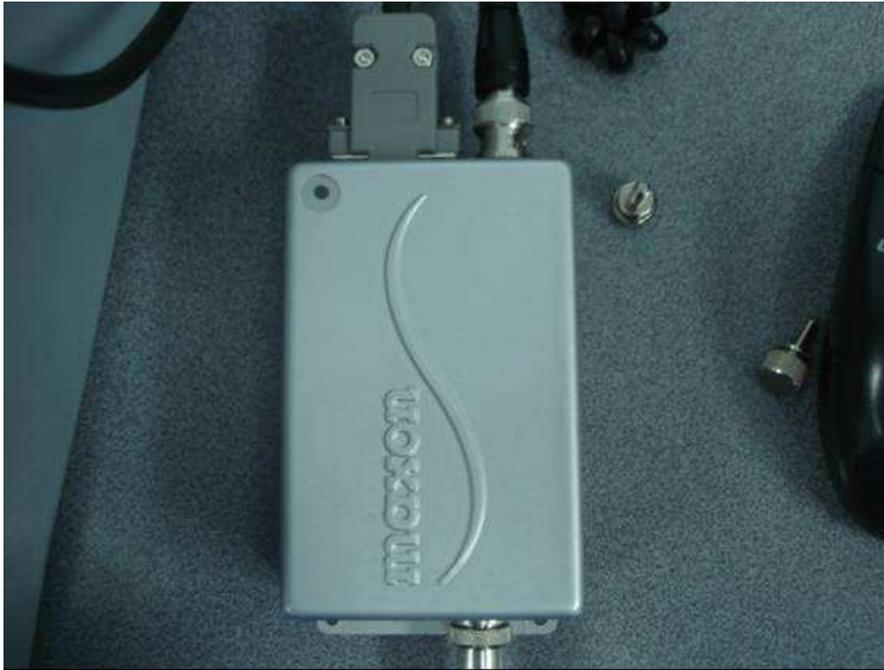
**Figura 2.15.** Radio Midlan. En la parte superior se pueden apreciar el puerto serial y la conexión de la antena.
