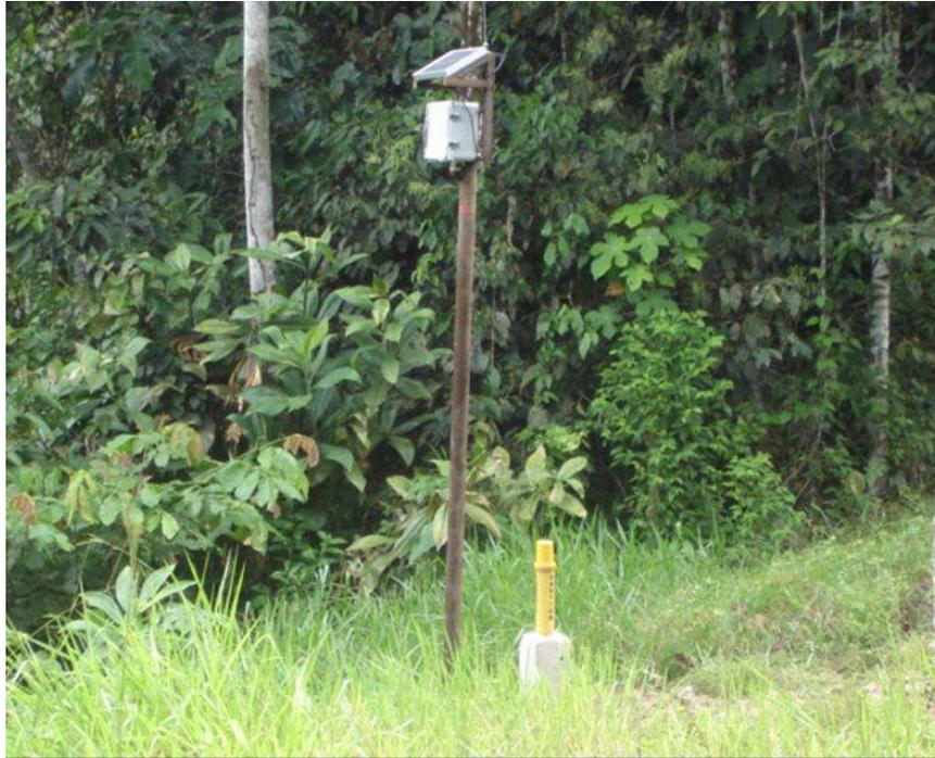
**Figura 2.26.** RTU instalado junto al poste de prueba existente.
