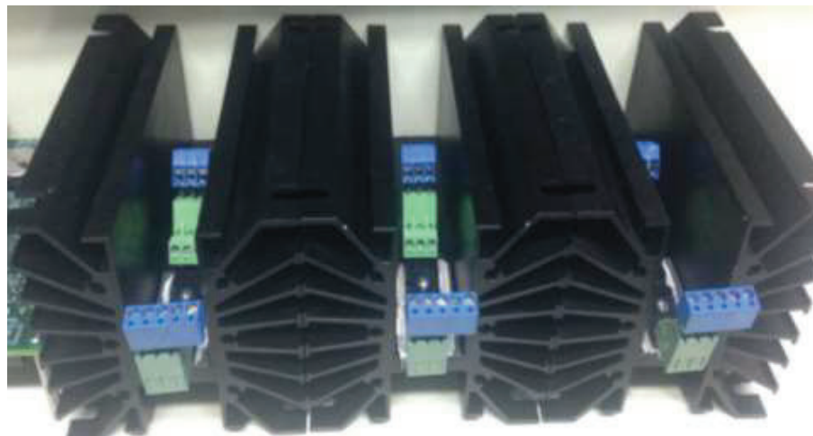
Figura 2.71 inversor trifásico montado en los disipadores de calor
