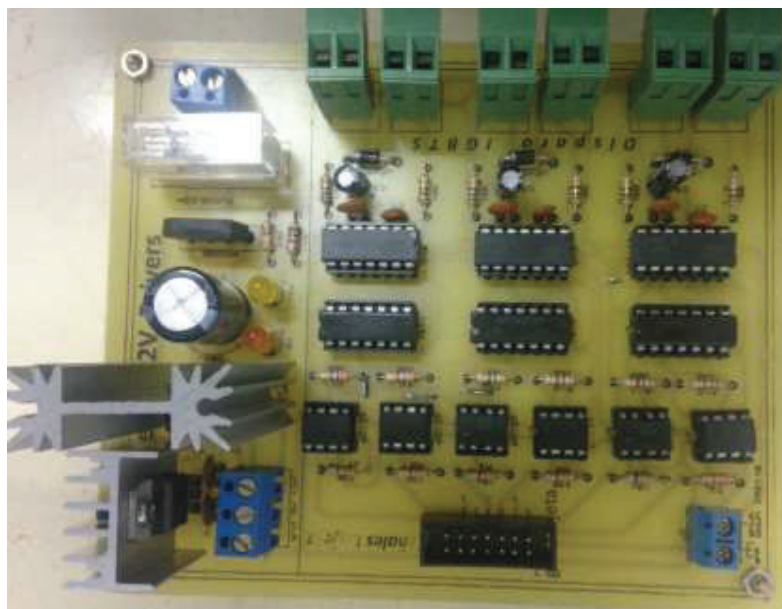
Figura 2.73 Placa circuito de disparo implementada
