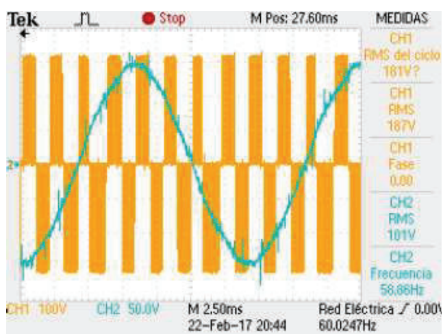
Figura H.4 Voltaje generado UV 8vo armónico
