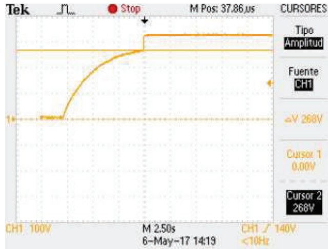
Figura 4.2 Forma de onda carga bus dc, visualización voltaje de activación del relé
