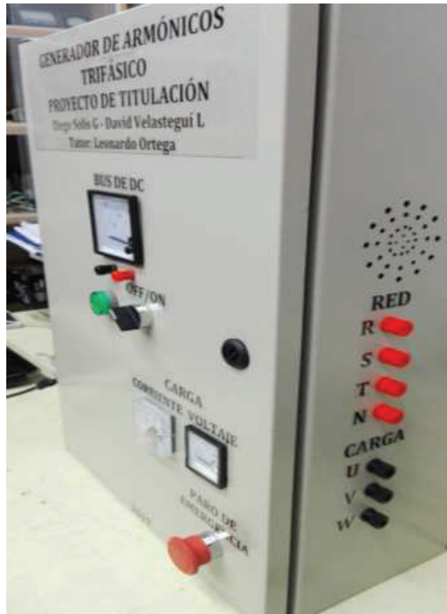
Figura 2.78 Sistema completo montado en gabinete metálico vista lateral
