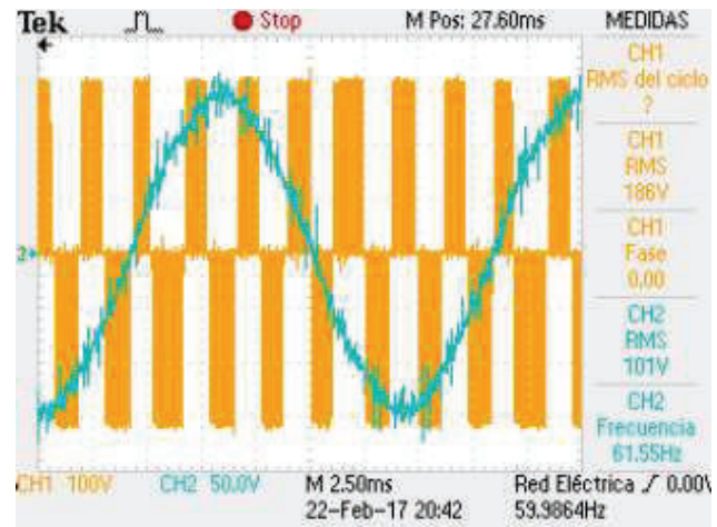
Figura 4.14 Voltaje generado UV 7mo armónico
