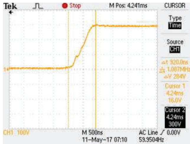
Figura 2.22 Forma de onda voltaje colector-emisor en el apagado
