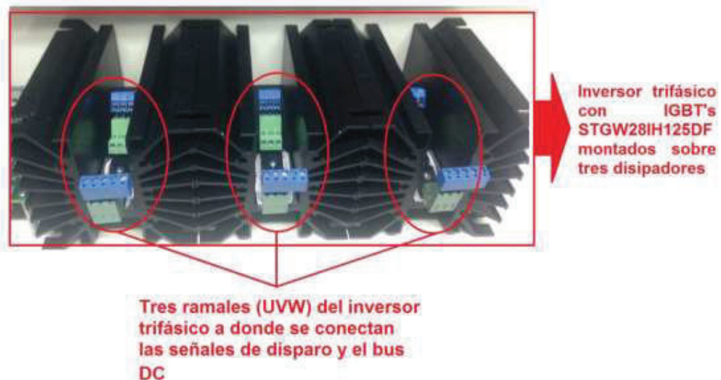
Figura A.8 Puente inversor trifásico montado sobre tres disipadores
