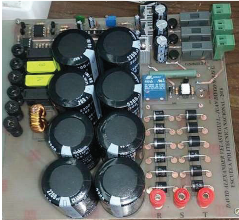
Figura 2.70 Placa BUS DC implementada
