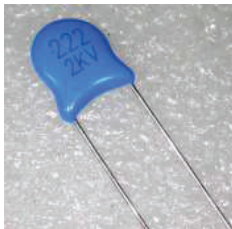
Figura 2.14 Capacitor 2.2nF, 2000V utilizado para red snubber
