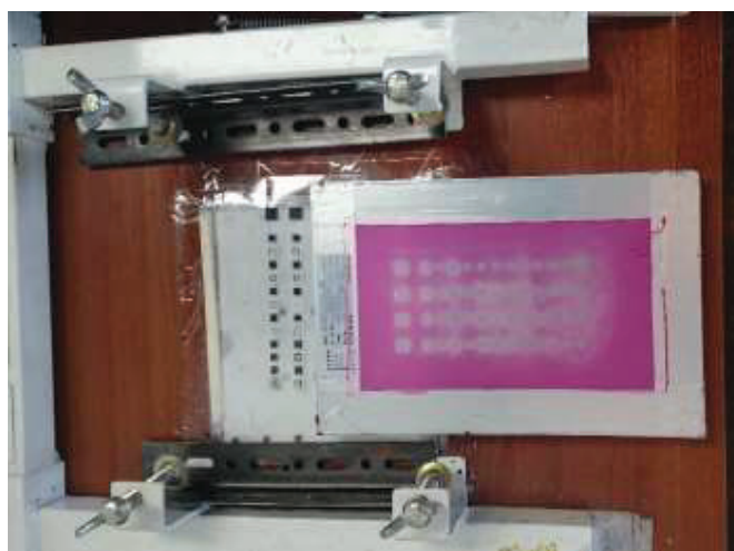
Figura 2.2. Equipo de serigrafía con una malla SEFAR.
