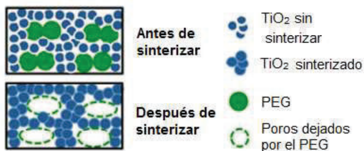
Figura 3.6. Comportamiento del PEG en las películas de TiO 2 . (Fuente: Yasin et al., 2016)
