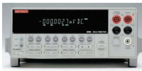
Figura 2.6. Voltímetro-Amperímetro Keithley 2000. (Fuente: Estrella, 2016)
