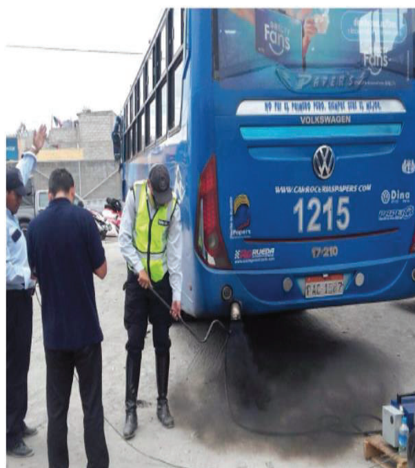
Figura 2.14. Medición de opacidad de bus de transporte público. (Fuente: Secretaria del Ambiente 2017)
