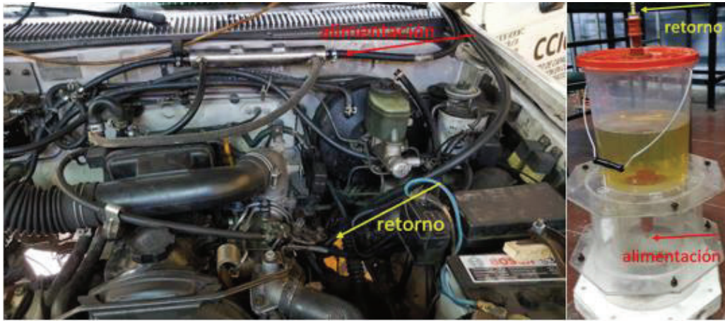
Figura 3.8. Adaptación de tanque externo de combustible en camionetas. (Fuente: Propia, 2017)
