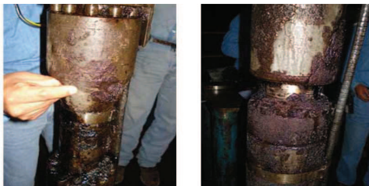
FIGURA 3.22: Muestra de sólido de HS-5 en W.O. 1 tomada del Intake FUENTE: PetroOriental S.A.
