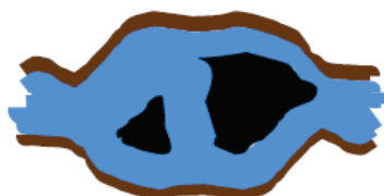
FIGURA 3.19: Entrapamiento por agua FUENTE: COPYR C. A.; Fluidos de perforación: FORMULACIÓN Y PREVENCIÓN DE DAÑO JULIO 2004
