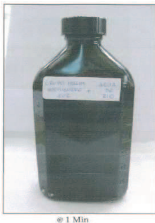
FIGURA 3.32: Prueba de compatibilidad entre agua fresca+ crudo de Hormiguero Sur 5 FUENTE: Mi Swaco
