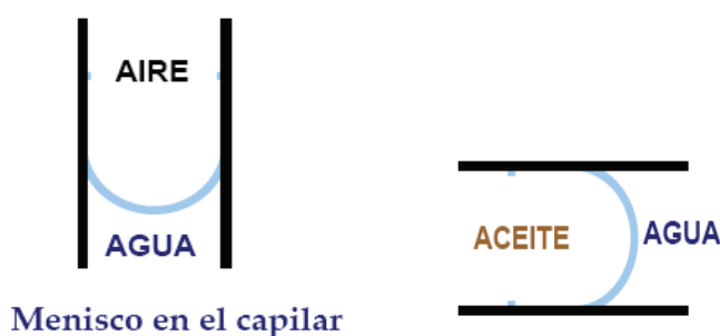
FIGURA 3.15: Menisco en la presión capilar
