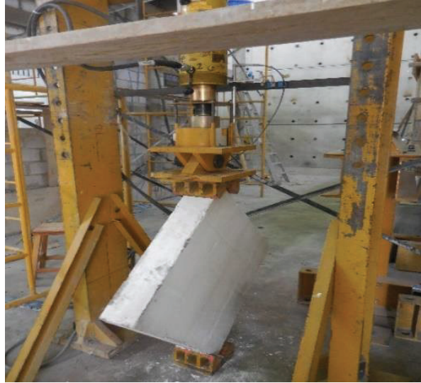
FOTOGRAFÍA 2. 6 ENSAYO DE TENSION DIAGONAL DE MURETES
