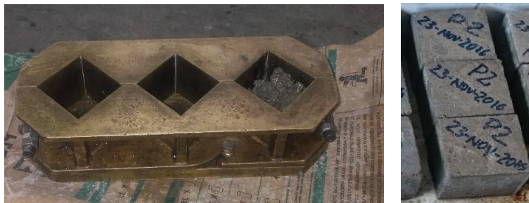
FOTOGRAFÍA 2. 3 MUESTRAS CUBICAS DE MORTERO
