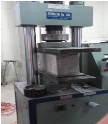
FOTOGRAFÍA 2. 2 ENSAYO A COMPRESIÓN DE BLOQUES
