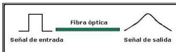
Fig. 1.1 Dispersión en una fibra óptica [1]
