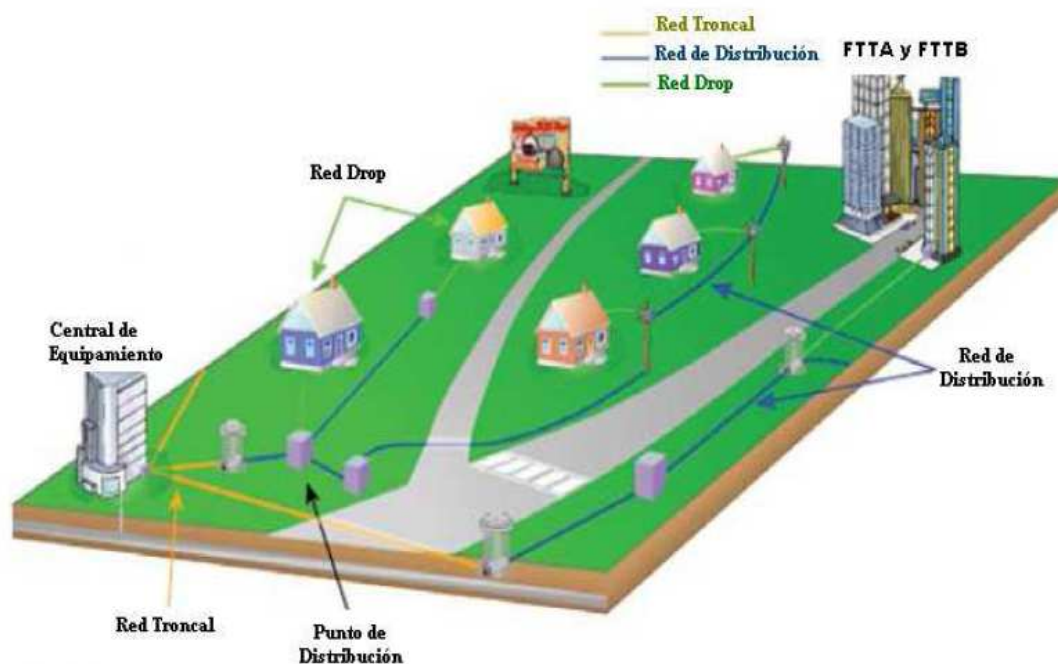
Fig. 3.9 Diagrama de la Red FTTH [9]
