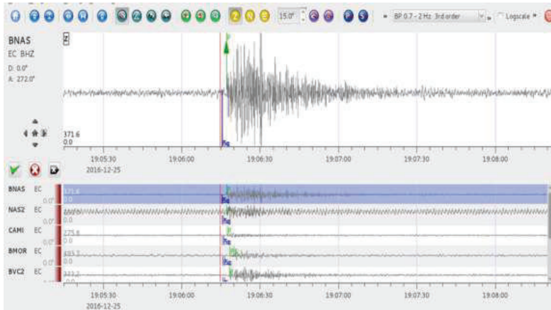
Figura 3. 3: Identificación manual de evento VT. La flecha verde indica el inicio del pulso de la onda P. Tomado de la base de datos del IG.
