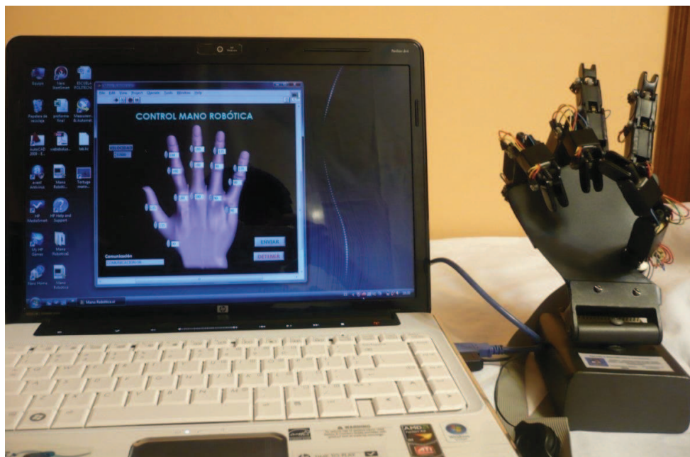
Figura 4.10 Funcionamiento desde la PC
