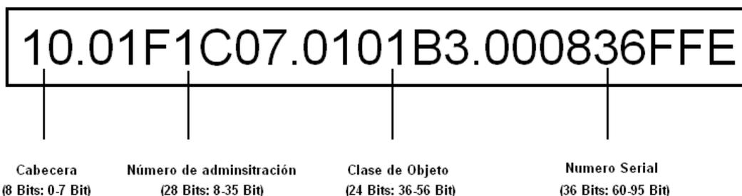
**Figura 2.27** Estructura del EPC de 96 Bits<sup>50</sup>
