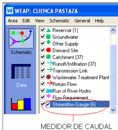
Figura 4.14 Medidor de caudal en el programa WEAP
