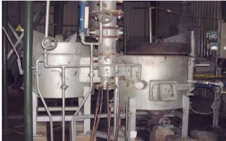
Figura 15: Horno Nicholls piloto utilizado para la reducción de las sales de cobre
