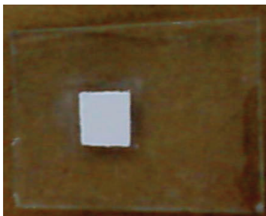
Figura 2.11. Muestra en polvo compactada en un portamuestras de vidrio.
