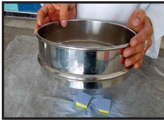
Figura 2.3. Aplicación de esmalte porcelánico por método de espolvoreo
