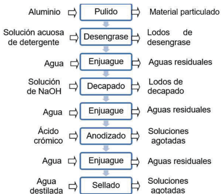
Figura 2.1. Diagrama de flujo del proceso del tratamiento superficial del aluminio por anodizado
