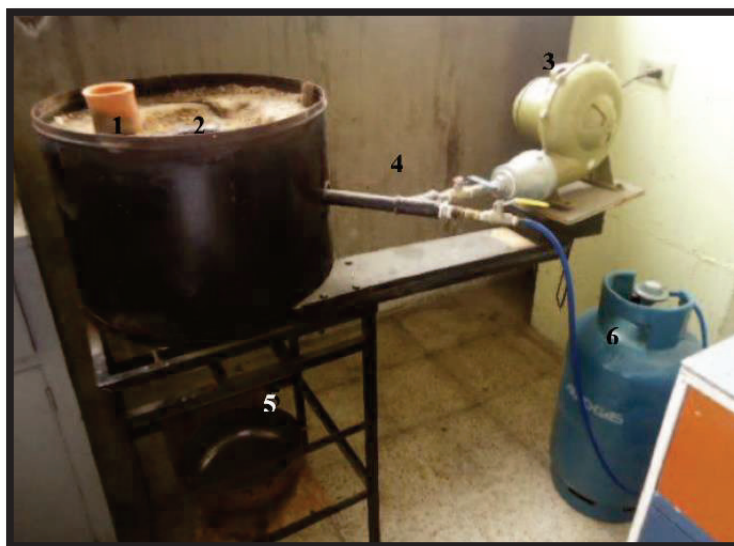
Figura 2.2. Horno de atronado, formado por: 1.- Crisol de atronado; 2.- Cámara de atronado; 3.- Ventilador; 4.- Tubería de ingreso de la mezcla aire-gas; 5.- Recipiente de cobre; 6.- Tanque de gas
