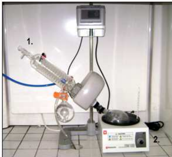
Figura 14: Equipo para recuperación del hexano: 1. rotavapor; 2. baño de agua
