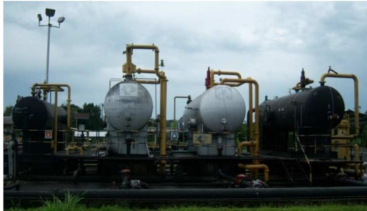
La fase líquida (crudo+agua) ingresa a la Bota de Gas (BO-005) en la cual se separa el remanente de gas existente en la corriente líquida.
