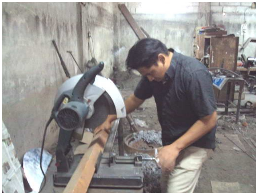
Figura 3.27 Corte de los perfiles del soporte de la tostadora
