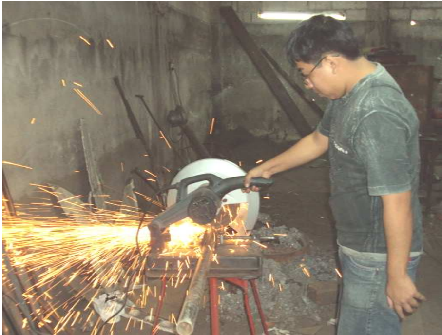
Figura 3.28 Corte del eje motriz de la cámara de tostado
