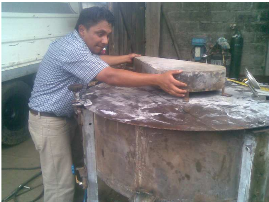
Figura 3.35 Montaje de la tapa de la polea
