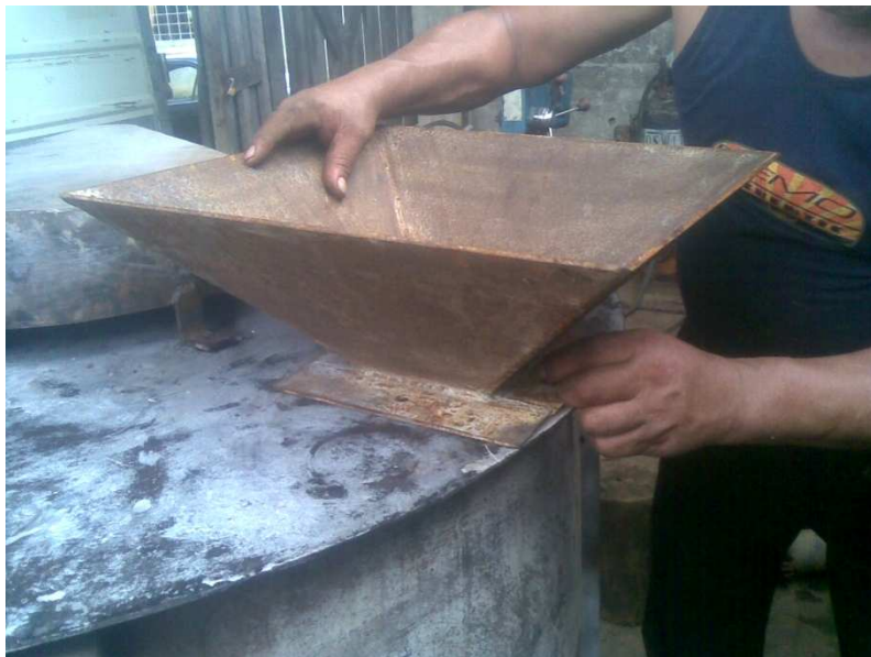
Figura 3.33 Montaje de la tolva
