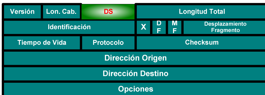
Figura 2.7 Cabecera IPv4 con DiffServ
