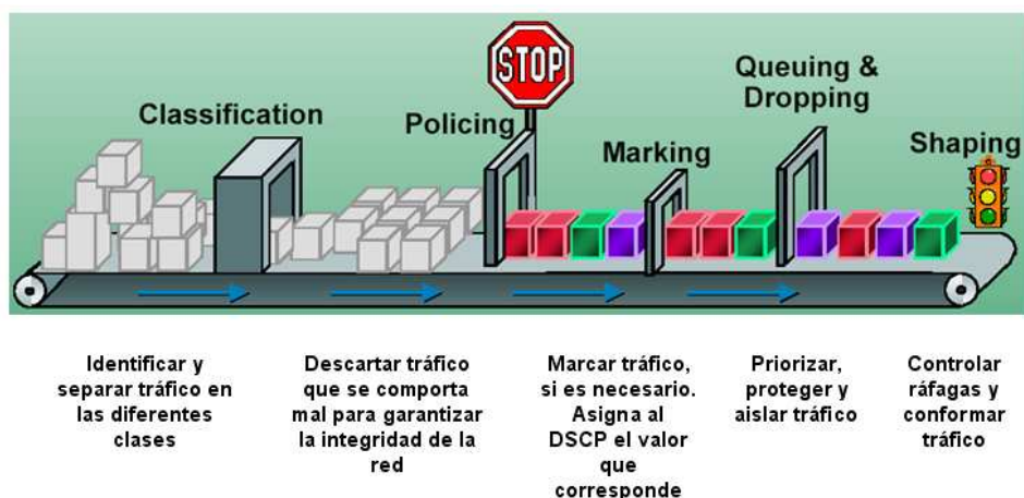
Figura 2.9 Implementación DiffServ en los ruteadores
