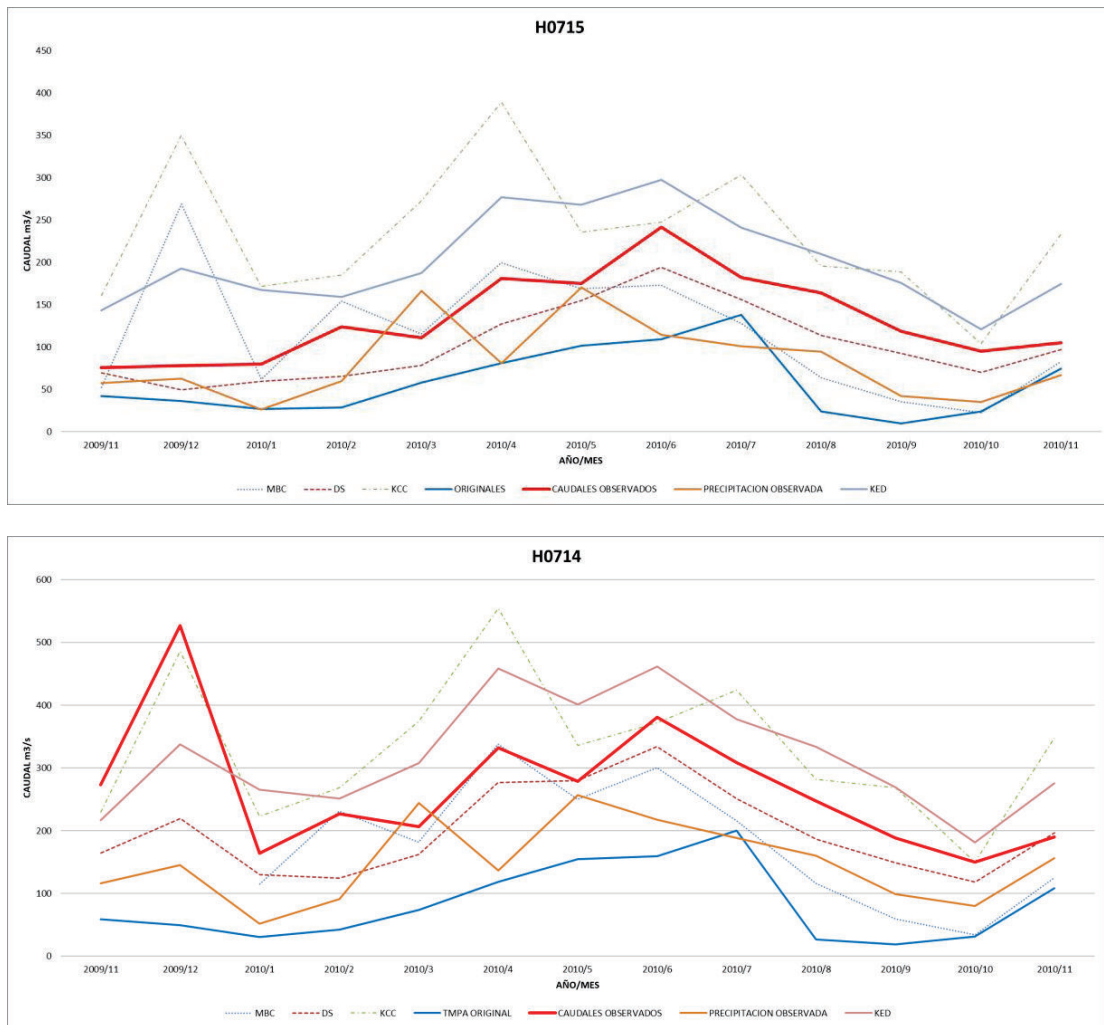
Figura 59. Hidrogramas de los caudales simulados con los valores corregidos del producto TMPA, valores sin corrección y caudales observados en las estaciones H0715 y H0714 desde octubre 2009 hasta noviembre 2010.
