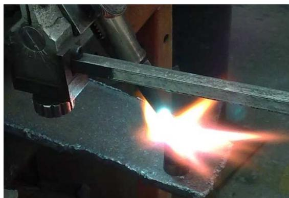
**Figura 6.9** Precalentamiento de la probeta
