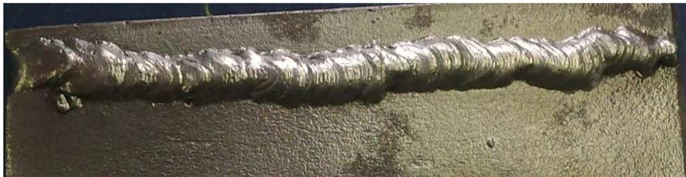
**Figura 6.3** Platina soldada con electrodo E-6013
