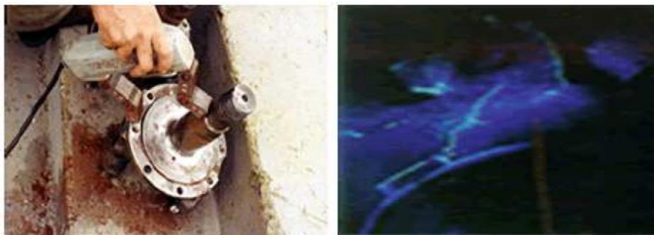
**Figura 1.6** Ensayo por Partículas Magnéticas
