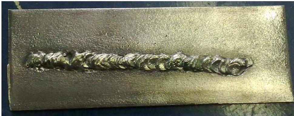
**Figura 6.1** Platina soldada con electrodo E-6010
