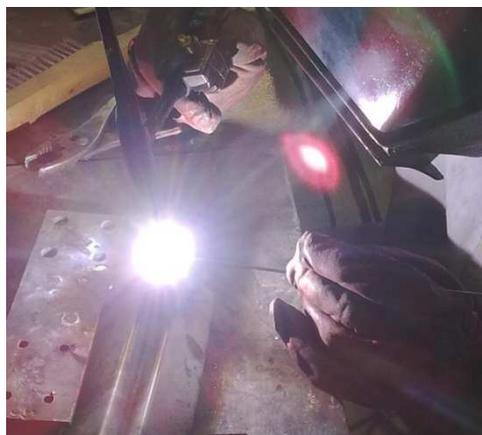
**Figura 6.11** Corodon de soldadura GTAW
