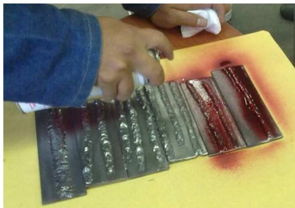
**Figura 6.15** Aplicación del penetrante
