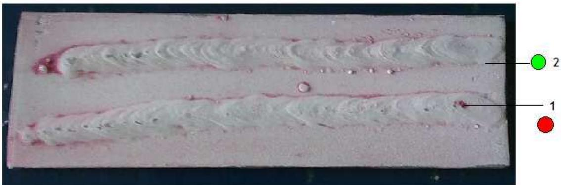
**Figura 6.19** Fallas en la soldadura SMAW
