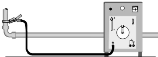
**Figura 2.21** Conexión a Tierra
