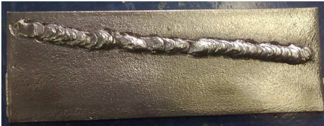
**Figura 6.2** Platina soldada con electrodo E-6011
