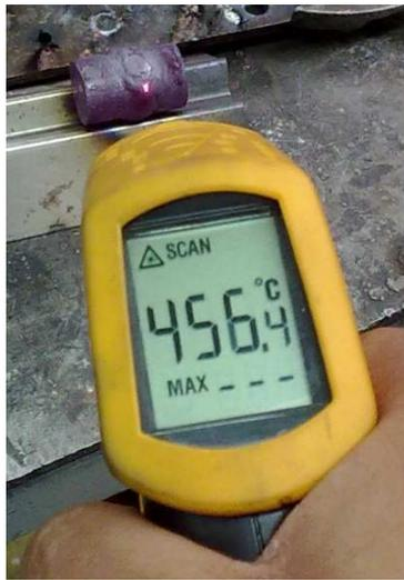
**Figura 6.10** Medicion de la temperatura de precalentamiento
