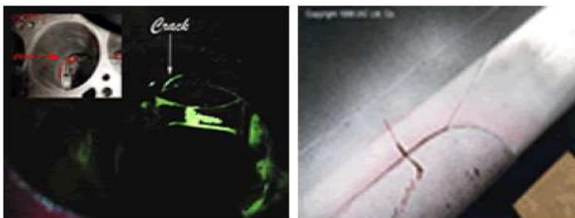
**Figura 1.5** Ensayo de Líquidos Penetrantes
