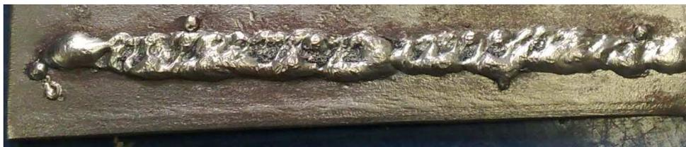
**Figura 6.7** Platina soldada en posición vertical
