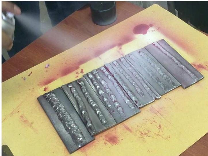
**Figura 6.17** Aplicación del revelador en las platinas
