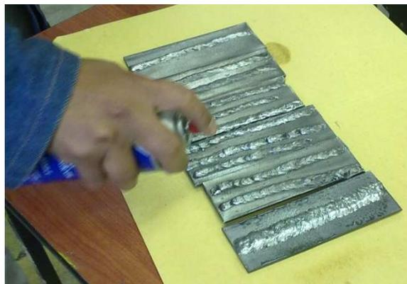
**Figura 6.14** Proceso de limpieza de la platina
