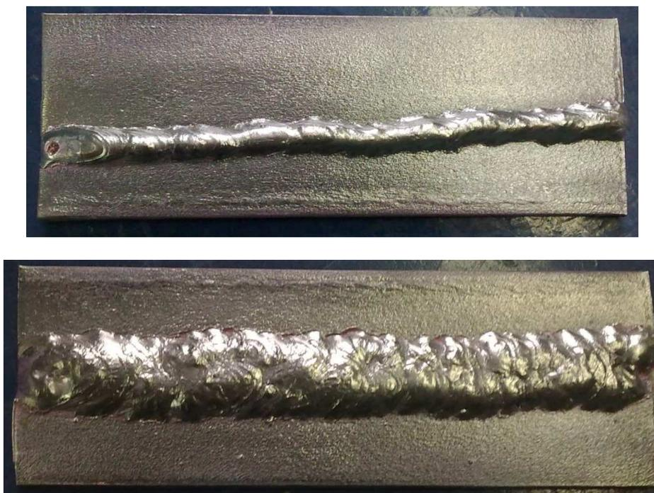
**Figura 6.8** Platinas soldadas con el proceso de soldadura GMAW
