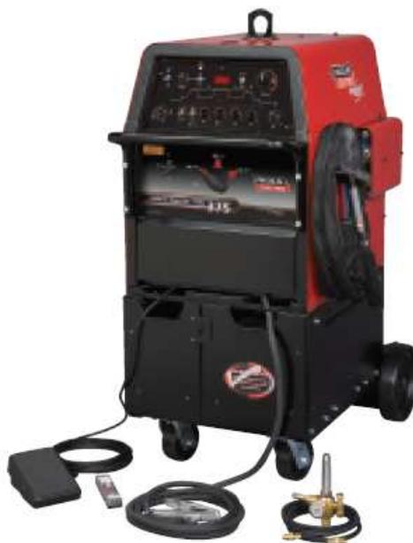
**Figura 4.6** Equipo de soldadura TIG
