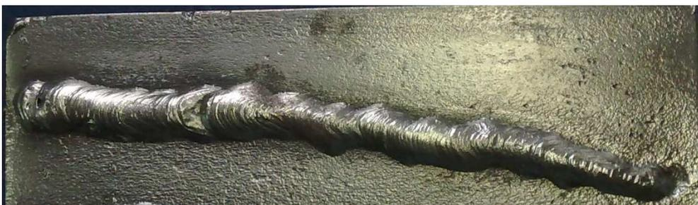
**Figura 6.4** Platina soldada con electrodo E-7018
