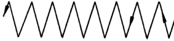
**Figura 3.11** Cordón de soldadura con movimiento perpendicular
