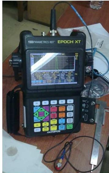
**Figura 6.22** Equipo para el ensayo de ultrasonido
