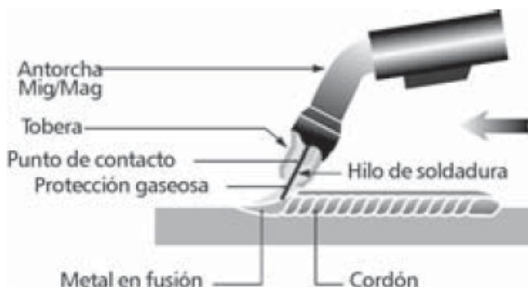
**Figura 3.1** Esquema representativo del proceso de soldadura GMAW
