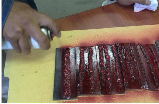
**Figura 6.16** Rocio completo del penetrante en las platinas
