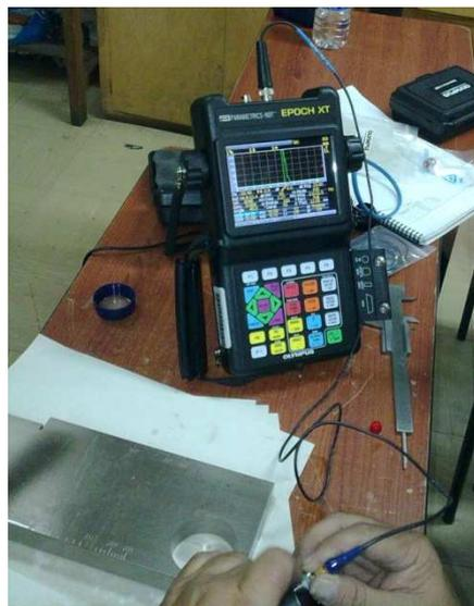
**Figura 6.23** Medicion de la probeta
