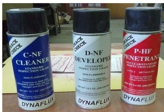
**Figura 6.13** Equipo para ensayo de tintas penetrantes
