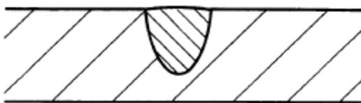
**Figura 4.2** Penetración con corriente continua, polaridad directa
