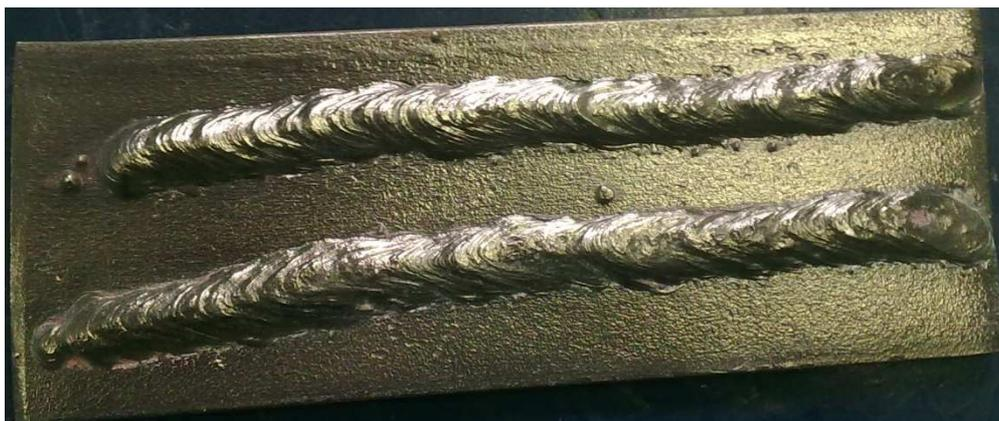
**Figura 6.5** Platina soldada con electrodo E-7024
