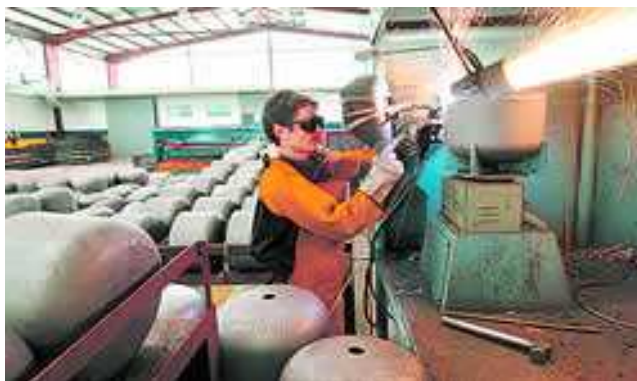
Gráfico 3.10, Soldadura del portaválvula.
