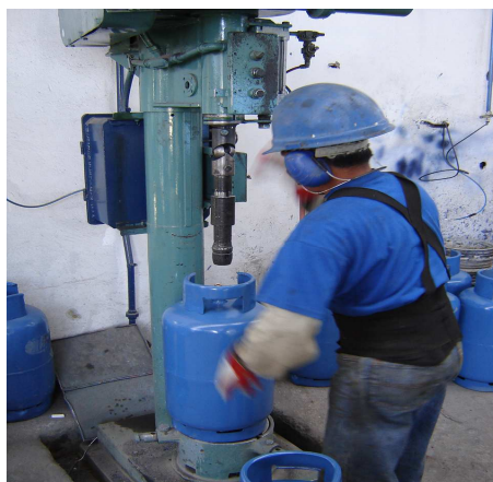
Gráfico 3.21. Colocación de válvula
