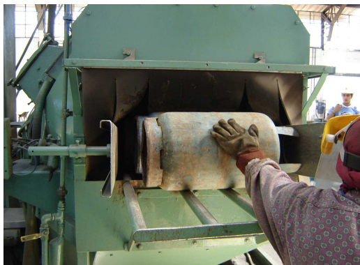
Gráfico 3.19. Granallado Imagen obtenida de Internet.
