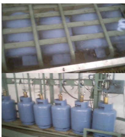
Gráfico 3.22. Prueba de estanqueidad. Imagen obtenida de Internet.
