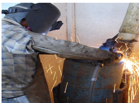
Gráfico 3.11, Soldadura de asa
