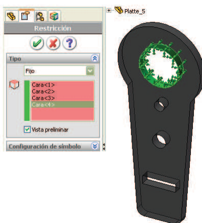
Figura 2.18 Definición de Restricciones: Partes fijas
