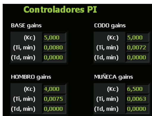
Figura 3.29 Ajuste de ganancias de los controladores PI de cada articulación
