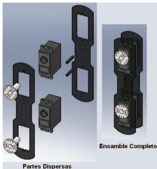
Figura 2.2 Ejemplo de ensamble en SOLIDWORKS
