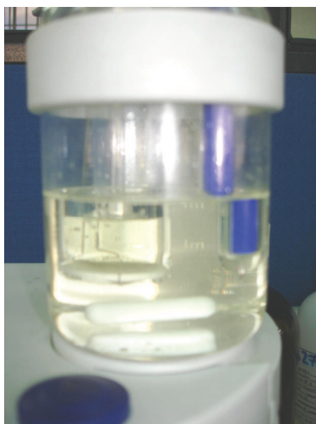
Figura 2.3. Fotografía de la celda de titulación y los niveles de las soluciones antes del encendido en el Titulador Coulométrico Karl Fischer, Mettler Toledo DL-32.
