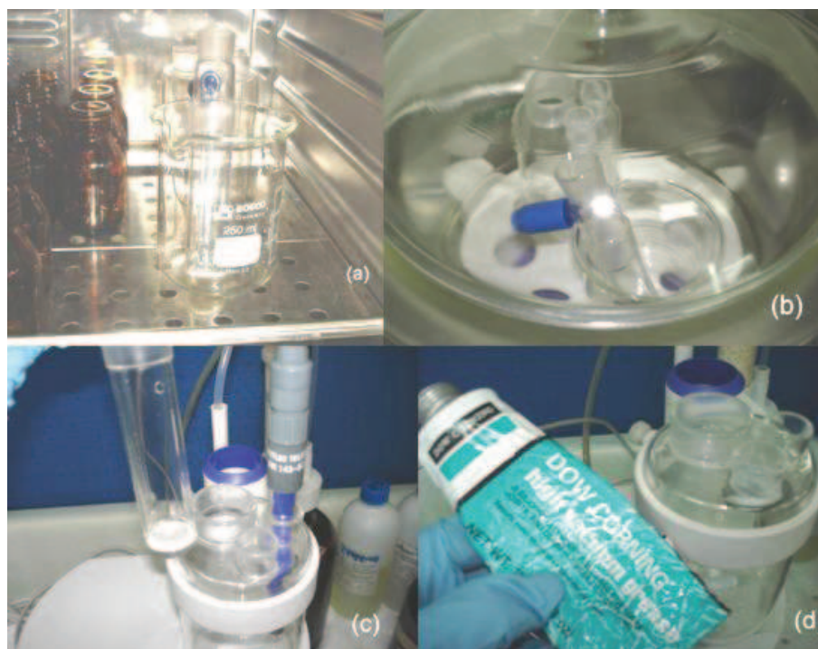
Figura 2.1. Secado y ensamblado del coulómetro Mettler Toledo DL32. (a) Secado de la celda de titulación y el electrodo generador en estufa a 70 °C. (b) Enfriamiento de la celda y el electrodo en el desecador para evitar adición de humedad ambiental. (c) Ensamblaje del equipo de acuerdo a las indicaciones del fabricante. (d) sellado de las uniones esmeriladas con grasa de silicona para alto vacío.
