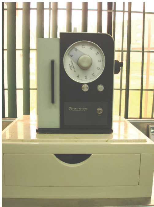
Figura 2.5. Fotografía del Tensiómetro Superficial Fisher donde se aprecia la mesa de mármol que ofrece estabilidad ante las vibraciones.
