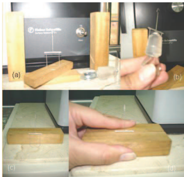
Figura 2.6. Primera parte de la rectificación de las propiedades del anillo de Pt – Ir. (a) Herramientas utilizadas. (b) Rectificación de la circunferencia del anillo. (c) Rectificación del plano de la circunferencia. (d) Control de plano de la circunferencia y del plano de los alambres sujetadores.
