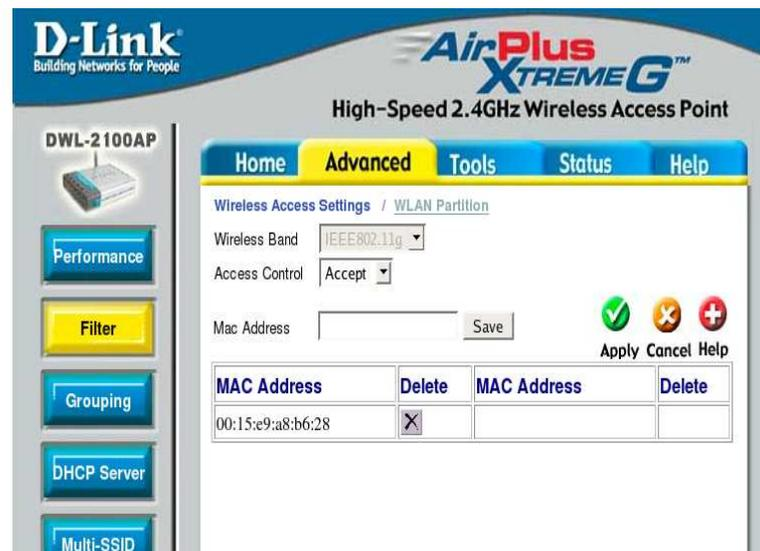
Figura 3. 13 Ventana de configuración de filtrado por direcciones MAC del Access Point
