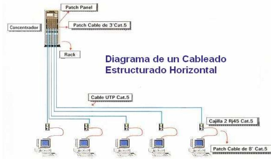
Figura 1.6 Diagrama del Cableado Estructurado Horizontal <sup>[3]</sup>
