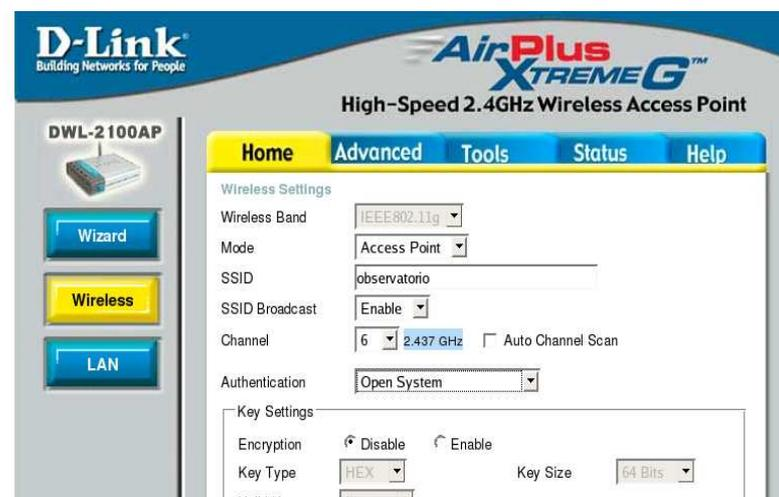
Figura 3. 12 Ventana de configuración básica del *Access Point*
