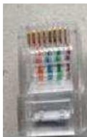
**Figura 3. 5** Conector RJ-45 con la normativa T568B
