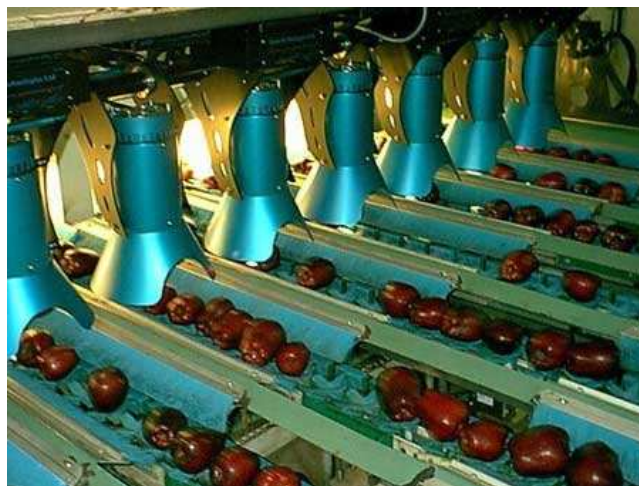
Figura 6. Detección de madurez por espectroscopia infrarrojo cercano en manzanas (Self, 2004)
