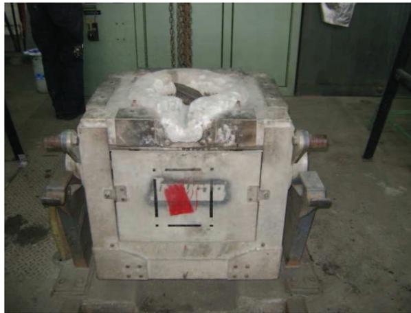
Figura 4.20 Horno de inducción para el colado de la coquilla
