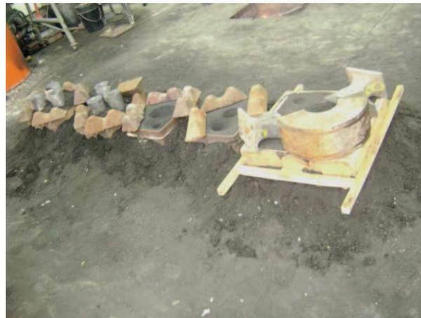
**Figura 4.22 Pesos colocados sobre los moldes**
