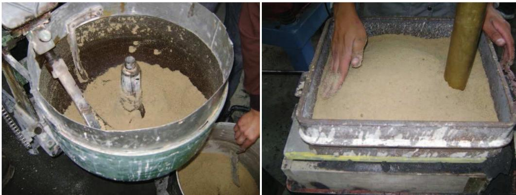
**Figura 4.18 a) Productos de moldeo en mezcladora, b) caja de moldeo con arena mezclada**
