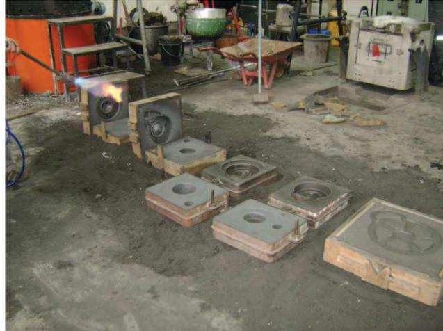
**Figura 4.21 Moldes colocados en la cama de arena calentados con llama**
