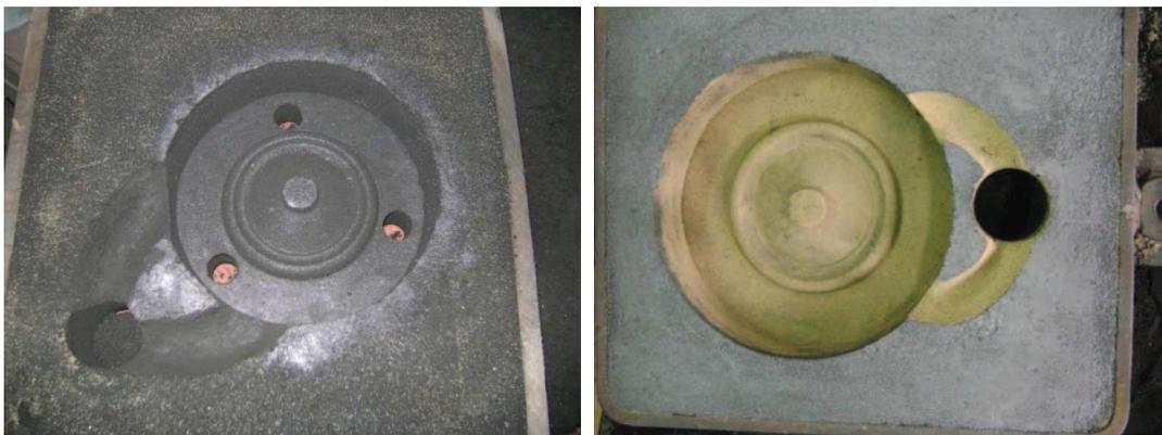
**Figura 4.17** Moldeo de la coquilla (a) con arena en verde, (b) arena con resina fenólica
