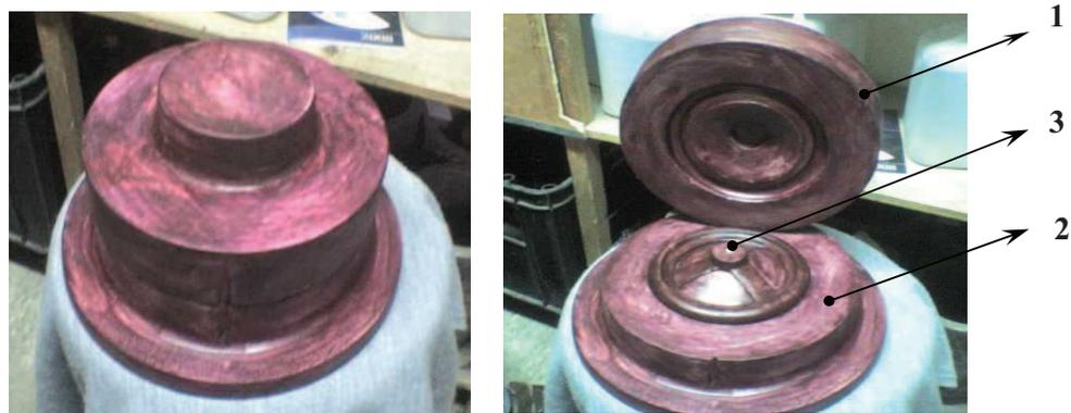
Figura 4.11 Modelo de madera de la coquilla
