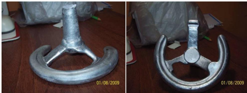
**Figura 6.6 Volante colado con molde estático**
