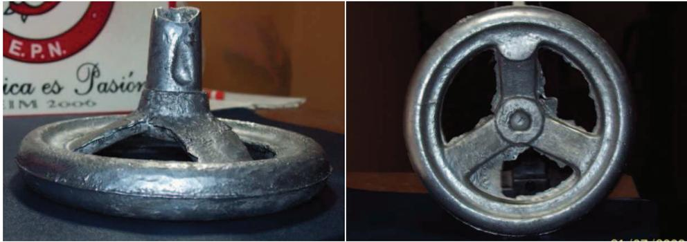
**Figura 6.5 Volante centrifugado a altas revoluciones**
