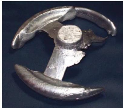
**Figura 6.4 Pieza incompleta por mala operación de colado**
