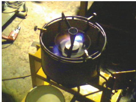
**Figura 6.2 Funcionamiento del sistema de llamas**
