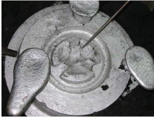
**Figura 4.16** Resultado de la segunda prueba de colado con aluminio
