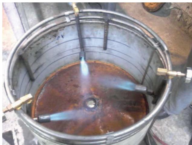
**Figura4. 65 Funcionamiento del sistema de llamas**
