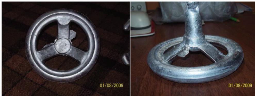
**Figura 6.7 Volante centrifugado correctamente elaborado**
