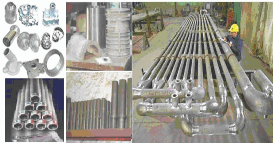
**Figura 2.16 Aplicaciones de la fundición centrífuga**
