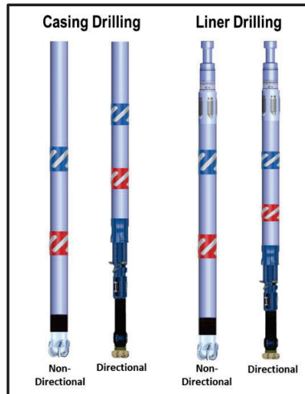
Figura 8. Tipos de Casing y Liner Drilling
