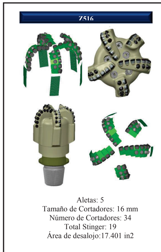
Figura 41. Broca de 8 1/2" para Casing while Drilling
