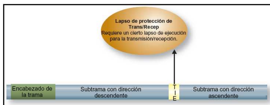
FIGURA 1.11. Tama MAC del sistema TDD Canopy.
