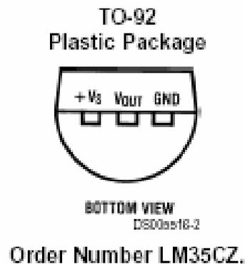
**Fig. 2.3** Sensor de Temperatura LM35
