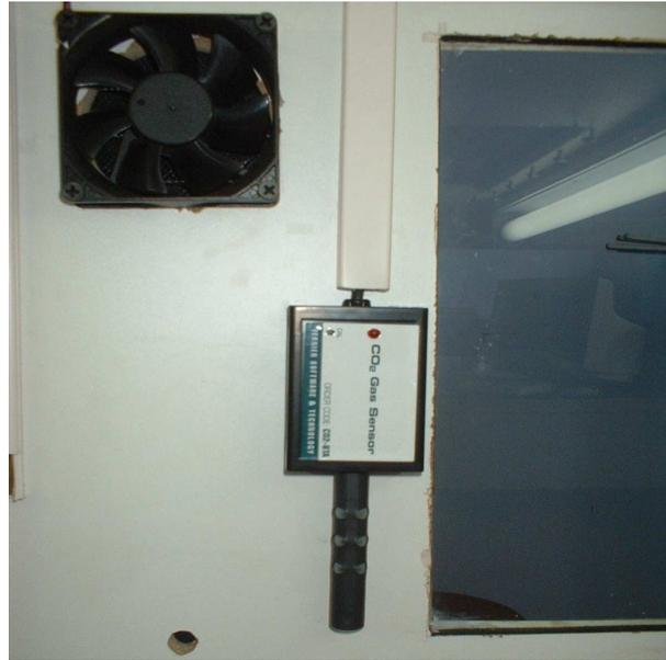
**Fig. 2.34** Disposición del sensor de CO<sub>2</sub> dentro del prototipo
