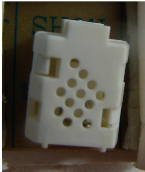
**Fig. 2.5** Sensor de Humedad Relativa
