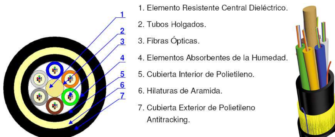
Figura 2.33 Estructura del cable óptico ADSS. [26]
