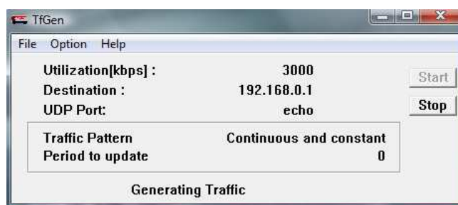
Figura 4.7 Utilización del programa TFGEN, IP de destino (192.168.0.1) y velocidad de transmisión 3000 Kbps [6]
