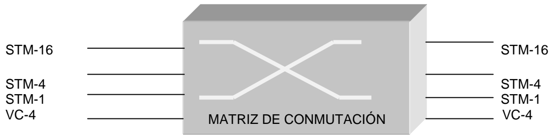
Figura 1.10 Matriz de conmutación de contenedores virtuales [8]
