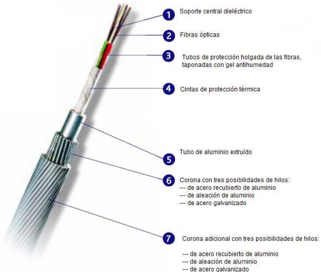
Figura 2.28 Cable óptico OPGW conformado por el núcleo óptico (1-2-3-4) y la protección metálica (5-6-7). [22]
