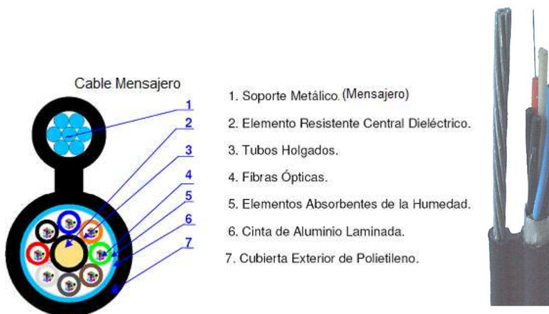
Figura 2.34 Estructura del cable óptico de Figura en 8. [26]
