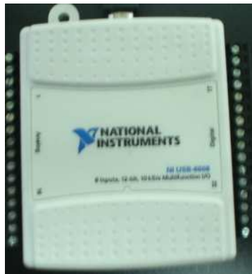
Figura 2.4 - Tarjeta de recepción de datos USB-6008, elaborada por National Instruments.
