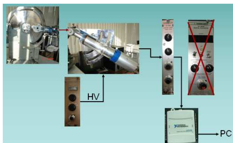
Figura 2.12 - Generación, recorrido y detección de la señal.
