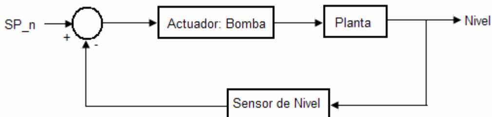
Figura 3.16: Diagrama De Control Para Error Positivo
