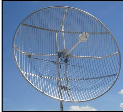
La antena está diseñada con reflector parabólico formado por elementos paralelos de aluminio soldados bajo atmósfera inerte de gas de argón, lográndose una estructura liviana y rígida con excelentes cualidades antioxidantes, permitiendo obtener mayor ganancia con menor peso y escasa resistencia al viento, reduciendo las exigencias en los mástiles de sustentación y facilitando la instalación.
