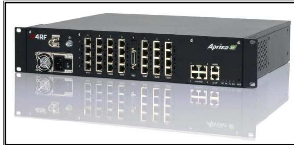
Las bandas de frecuencia en las cuales opera el equipo son: de 300 MHz hasta 2.7 GHz llevando tráfico Ethernet<sup>31</sup>, voz y datos sobre distancias superiores a 100 kilómetros.
