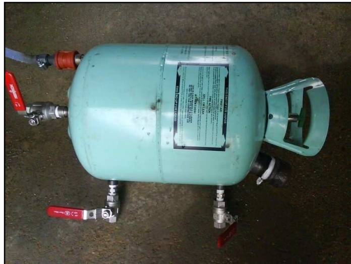
Figura 5.9. Prueba de hermeticidad del tanque de combustible.
