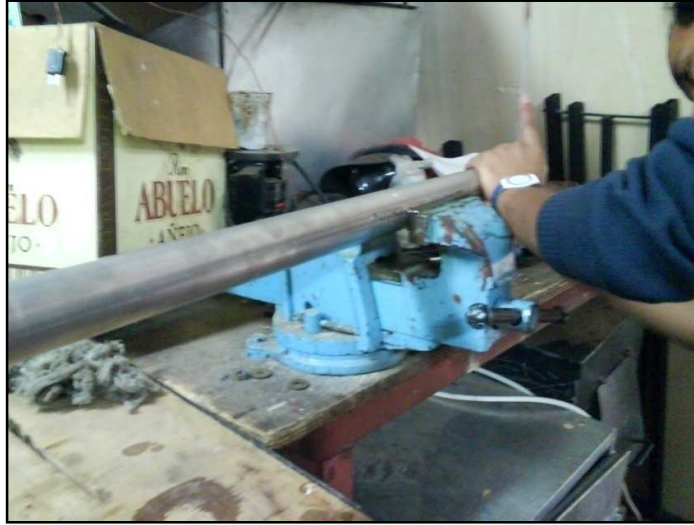
Figura 5.2. Proceso de corte de las tuberías
