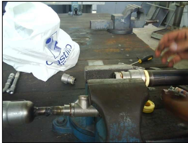
Figura 5.10. Unión de los accesorios del precalentador de combustible.
