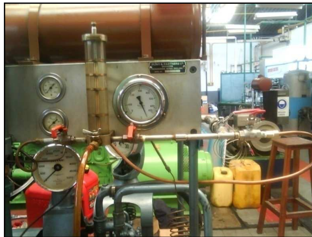
Figura 5.16. Acople del precalentador de combustible al sistema de alimentación de combustible.
