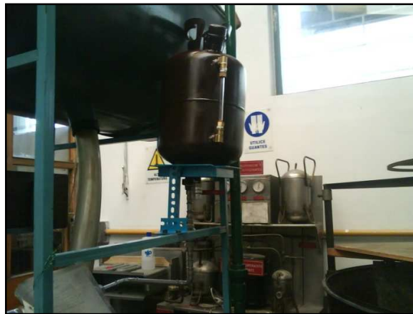
Figura 5.15. Montaje del tanque de combustible.
