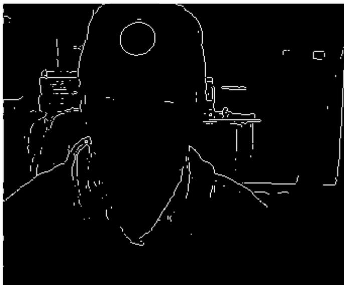
Figura 2.2. 5 Detección de bordes mediante algoritmo de PREWITT
