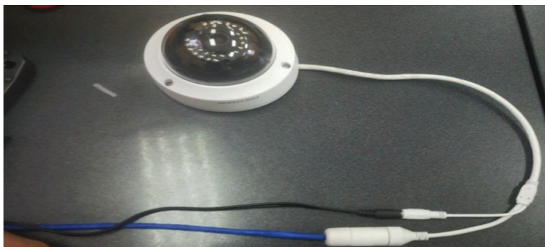
Figura 21 Conexión final de las cámaras
