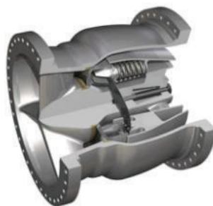
Gráfico 39. Esquema de la vista de corte parcial de una válvula de chorro hueco. (Fuente: Trunnion, 2008)
