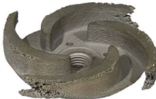
Fotografía 14. Rodete con cavitación de una bomba hidráulica. (Fuente: Instituto Argentino de la Energía, 2015)
