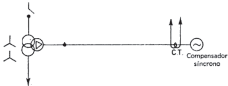
Figura 2.7 Compensador sincrónico conectado al terciario del transformador [14].
