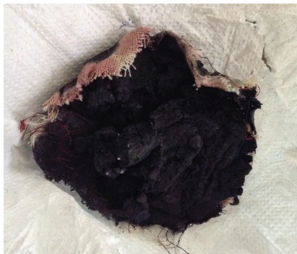
Figura 3.2 Residuo de la destilación del fondo de destilación
