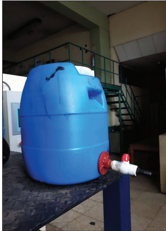
Figura 3.8 Tanque alerno de alimentación
