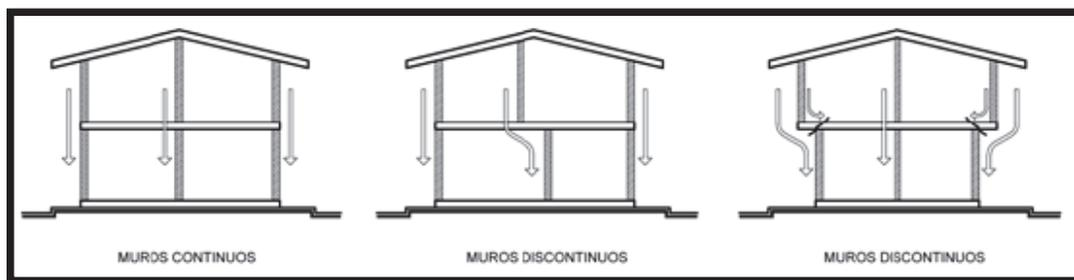
FIGURA 2-9. CONTINUIDAD VERTICAL DE MUROS.
