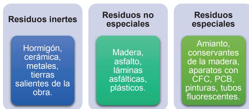
FIGURA 2-10. CLASIFICACIÓN DE LOS RESIDUOS DE CONSTRUCCIÓN.
