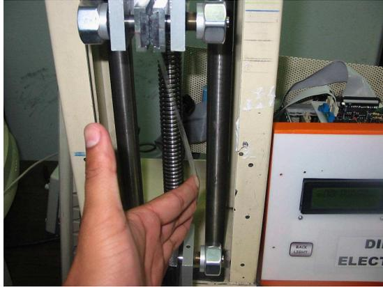
**Fig. 4.12** Dinamómetro TC200 realizando una Prueba de Tensión
