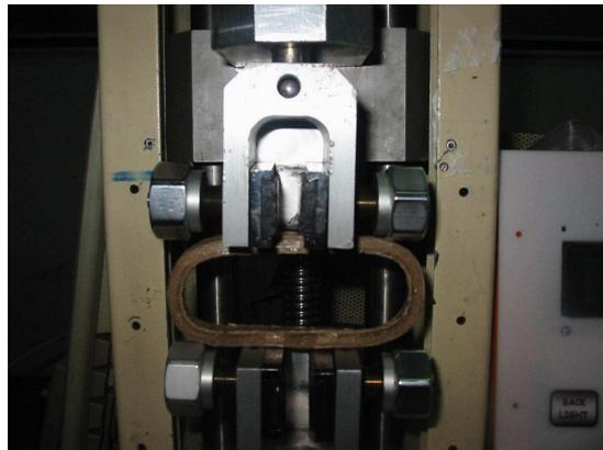
**Fig. 4.13** Dinamómetro TC200 realizando una Prueba de Compresión.
