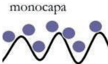
FIGURA 2.1 ESQUEMA DE DISTRIBUCIÓN DE IONES EN ADSORCIÓN QUÍMICA.
