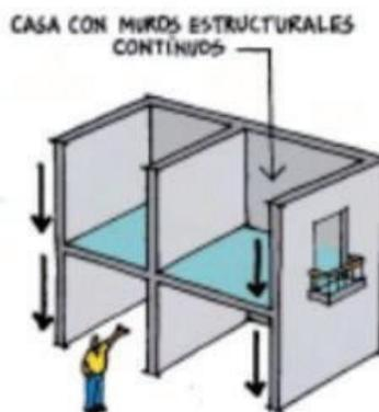
**GRÁFICO 0.2:** Esquema de mampostería portante, sujeta a carga vertical. **Fuente:** Asociación Colombiana de Ingeniería Sísmica
