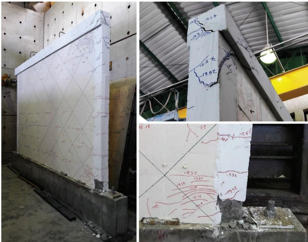
**GRÁFICO 0.36:** Muro de M.R.A. posterior al primer ciclo de carga lateral.
