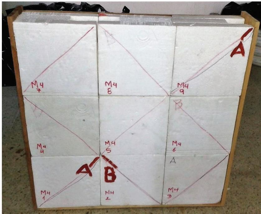
**GRÁFICO 0.5:** Disposición de bloques dentro del encofrado.
