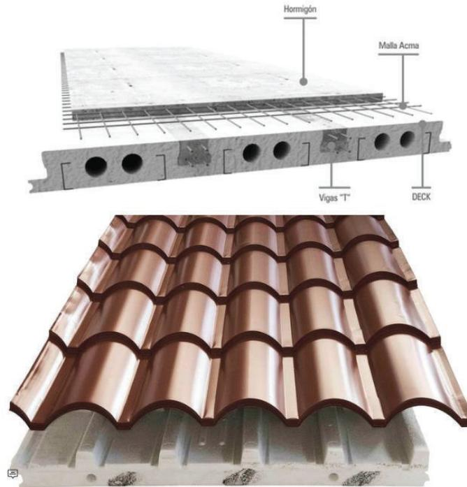
**GRÁFICO 0.14:** Losas y techos con poliestireno expandido. **Fuente:** Syntheon.
