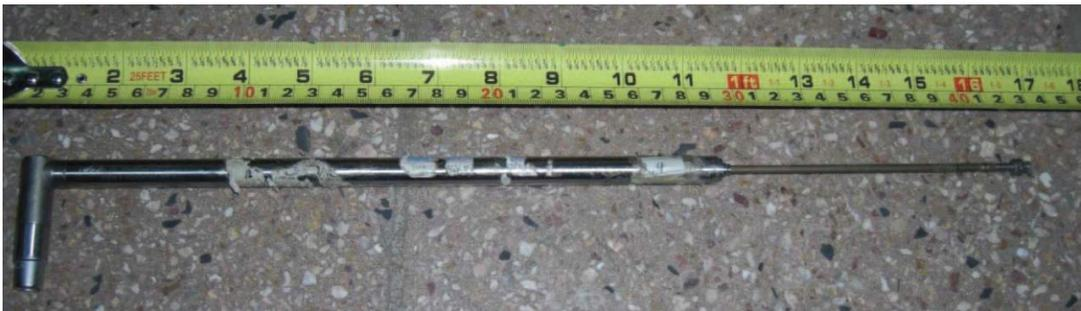
**GRÁFICO 0.31:** LVDT “medidor digital de desplazamiento”.
