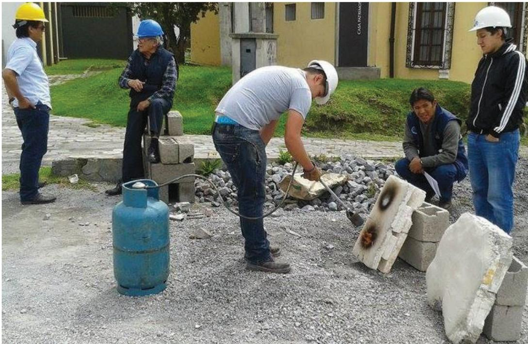
**GRÁFICO 0.55:** Ensayo de combustión de bloques de M.R.A..
