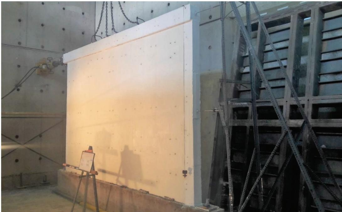
**GRÁFICO 0.34:** Ensayo a carga lateral del muro de M.R.A.
