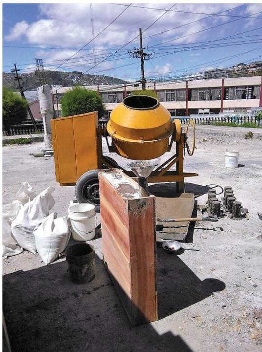
**GRÁFICO 0.7:** Preparación y asentamiento del micro-hormigón.
