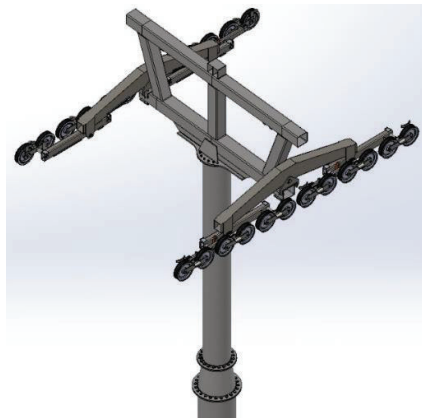
Figura 21. Tren de poleas instalado en torre de teleférico.
