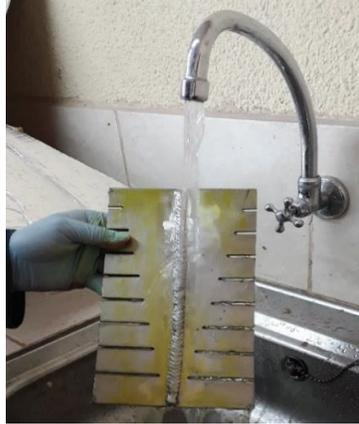
Figura 2.57. Lavar exceso de penetrante.
