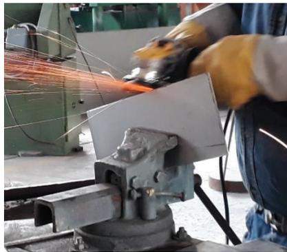
Figura 2.8. Preparación de probetas con esmeril.
