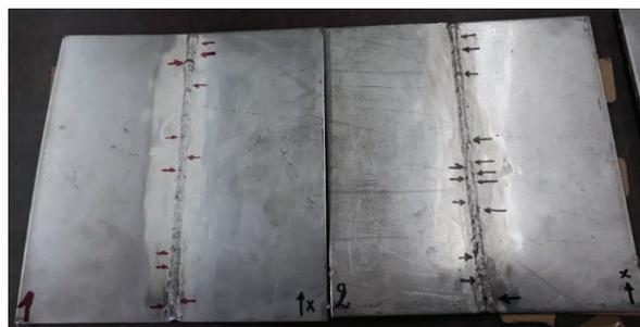
Figura 2.17. Señalización de posibles defectos en probetas con espesor 3 mm, el (1) transferencia Spray y (2) Transferencia cortocircuito.
