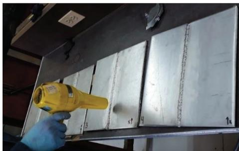
Figura 2.20. Secado después de la limpieza en la superficie.
