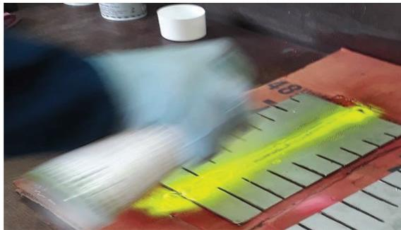
Figura 2.55. Aplicación de penetrante.
