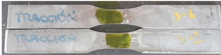
Figura 2.31. Identificación de cordón de soldadura en junta.
