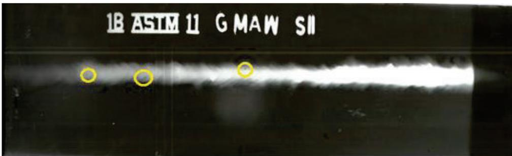
Figura 3.4. Radiografía 4 - transferencia por spray.
