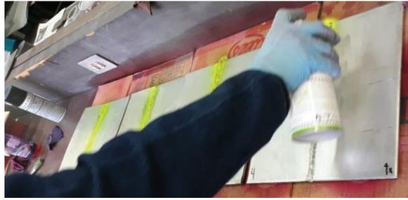
Figura 2.21. Aplicación de penetrante.
