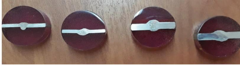
Figura 2.44. Probetas para metalografías
