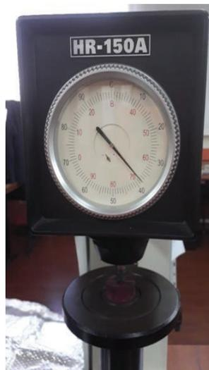
Figura 2.47. Durómetro HR - 150 A
