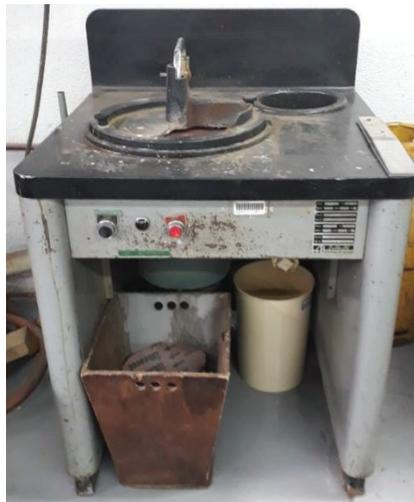
Figura 2.37. Máquina para desbaste grueso.
