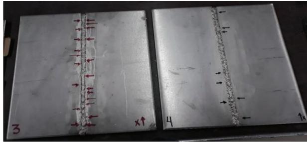
Figura 2.18. Señalización de posibles defectos en probetas con espesor 6 mm, el (1) transferencia Spray y (2) Transferencia cortocircuito.
