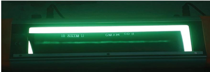
Figura 2.27. Negatoscopio.
