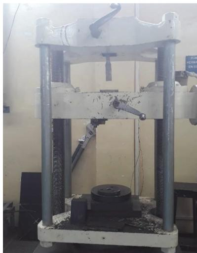
Figura 2.33. Colocación de probeta en la maquina universal de ensayos.
