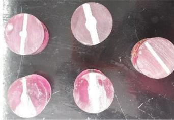
Figura 2.38. Corte y montaje de juntas soldadas y material base.
