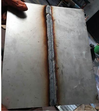
Figura 2.14. Cordón de soldadura GMAW e = 3 [mm].
