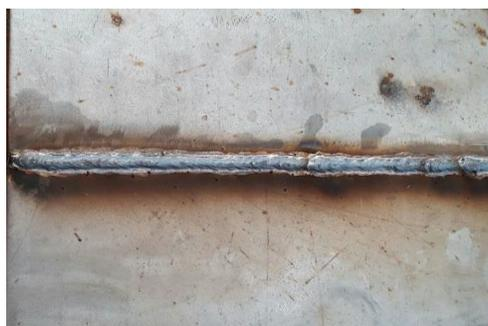
Figura 2.13. Soldadura GMAW  $e = 6$ [mm].
