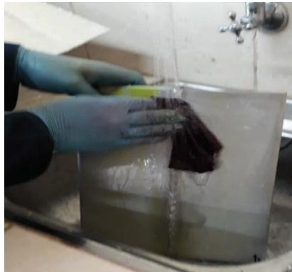
Figura 2.23. Lavar exceso de penetrante.
