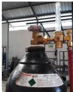
Figura 2.6. Tanque de Argón al 100%.
