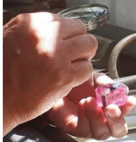
Figura 2.41. Secar la probeta de alcohol
