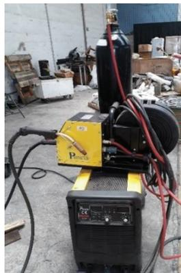
Figura 2.10. Equipo de soldadura MIG.
