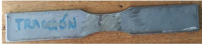
Figura 2.30. Probeta preparada para ensayo de tracción.
