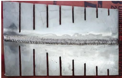
Figura 2.50. Obtención de soldadura para ensayo Houldcroft.
