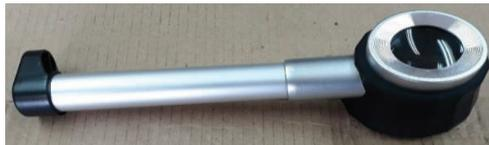
Figura 2.16. Lente utilizado para determinar discontinuidades.
