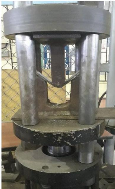
Figura 2.36. Probeta colocada en la máquina para ensayo de doblado.
