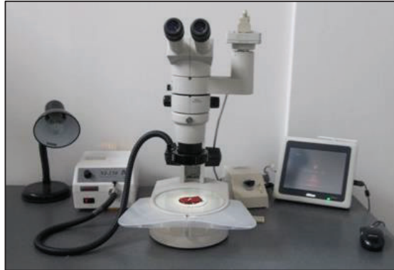
Figura 1.5. Estéreo Microscopio. Marca NIKON Modelo: SMZ800 Fuente: (Laboratorio de Materiales de la Universidad Nacional de Colombia, 2017).
