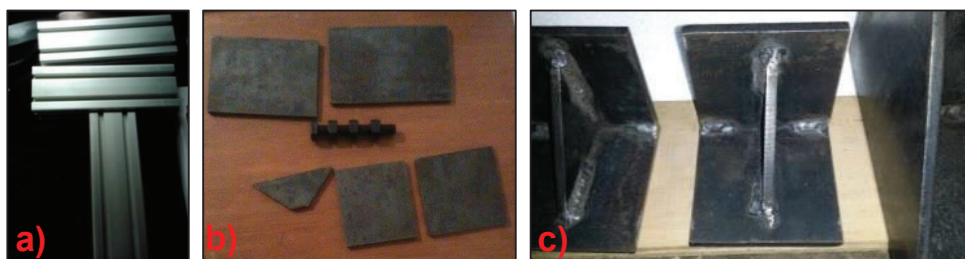
Figura 2.59. a) Perfiles cortados, b) Corte de las placas de acero A-36, c) Placas soldadas para formar las bisagras y la sujeción pistón-perfil.
