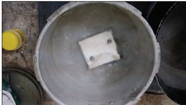
Figura 3.7. Inmersión de yeso blanco en agua a temperatura ambiente. (Fuente: Propia)
