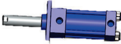
Figura 2.6. Carga dinámica con mecanismo cilindro hidráulico. (Fuente: Propia).
