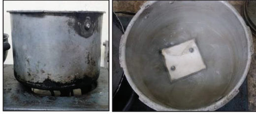
Figura 3.2. Yeso blanco sumergido en agua a temperatura de ebullición. (Fuente: Propia)
