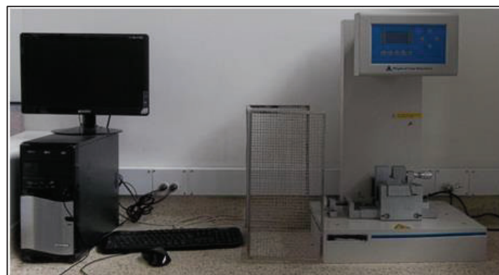
Figura 1.4. Máquina de Impacto. Marca Physical Test Solution (Computer Controlled Impact Testing Machine), modelo: ITC-XJU-22. Fuente: (Laboratorio de Materiales de la Universidad Nacional de Colombia, 2017).
