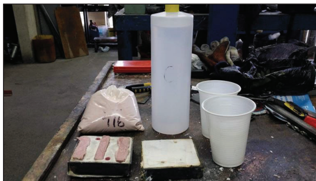
Figura 3.4. Mezcla de polímero en el molde de yeso blanco. (Fuente: Propia)
