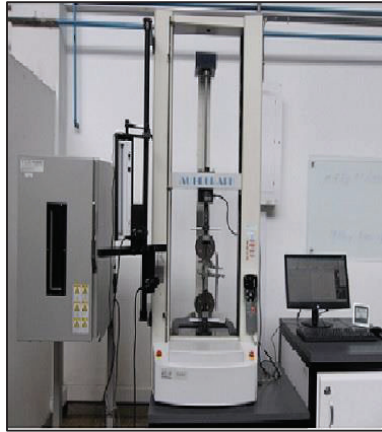
Figura 1.3. Máquina universal de ensayos. Marca Shimadzu®, modelo Autograph.AG-IS 5KN. Fuente: (Laboratorio de Materiales de la Universidad Nacional de Colombia, 2017).
