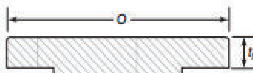
Figura AIII. 9. Esquema de la nomenclatura utilizada para las dimensiones de las bridas (Sinnott y Towler, 2013, p. 614)
